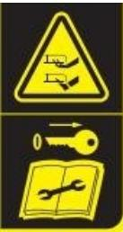
UPOZORENJE – Uklonite uređaj za onemogućavanje prije rada ili podizanja stroja.
