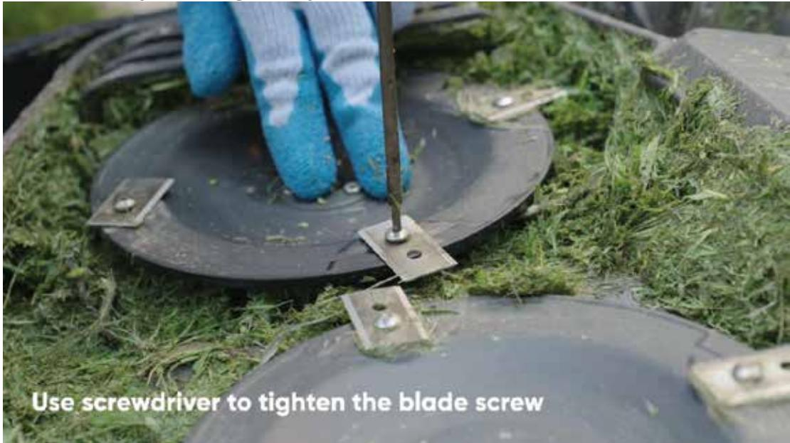
Držite reznu ploču mirno i pomoću odvijača olabavite vijak na reznim pločama.
