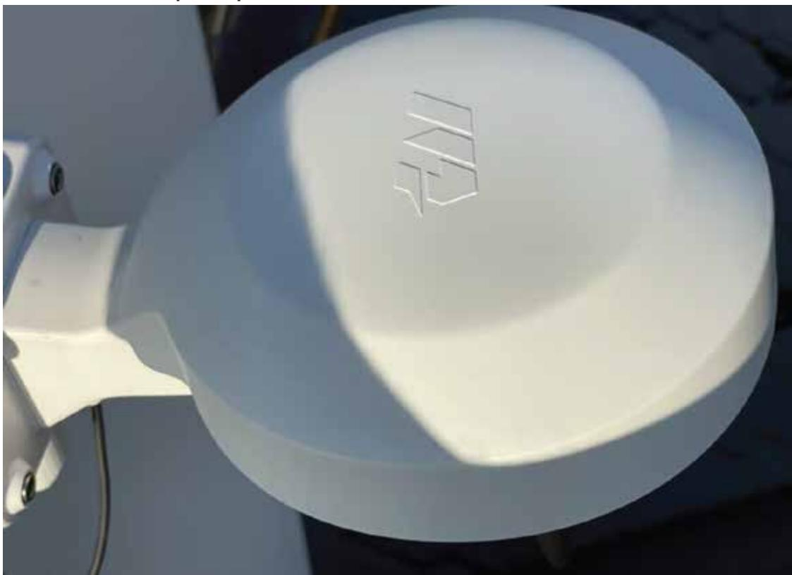
RTK stanicu ostavite pričvršćenu tijekom zime, možete je pokriti plastičnom vrećicom. Pazite da temperatura tijekom zime bude viša od -20°C/-4°C
